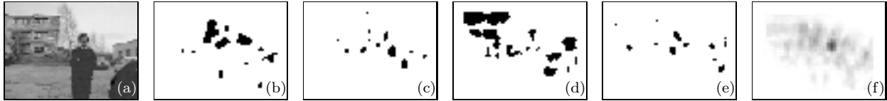
Abbildung 5.13: Beispiele von Ergebnissen der konturbasierten Personenlokalisierung im Außenbereich: Hier ist in (a) die Homogenität des Hintergrundes gegenüber Abb. 5.11 deutlich herabgesetzt. Die Auflösung ist eine halbe Oktave feiner, die Distanz zur Kamera damit etwa eine halbe Oktave größer. Auch hier erfolgt im Ähnlichkeitsmaß (f) eine deutliche starke Häufung hoher Werte korrespondierend zum Kopf der Person. – Zur Bedeutung der Einzelbilder (a) bis (f) siehe Abb. 5.11.
