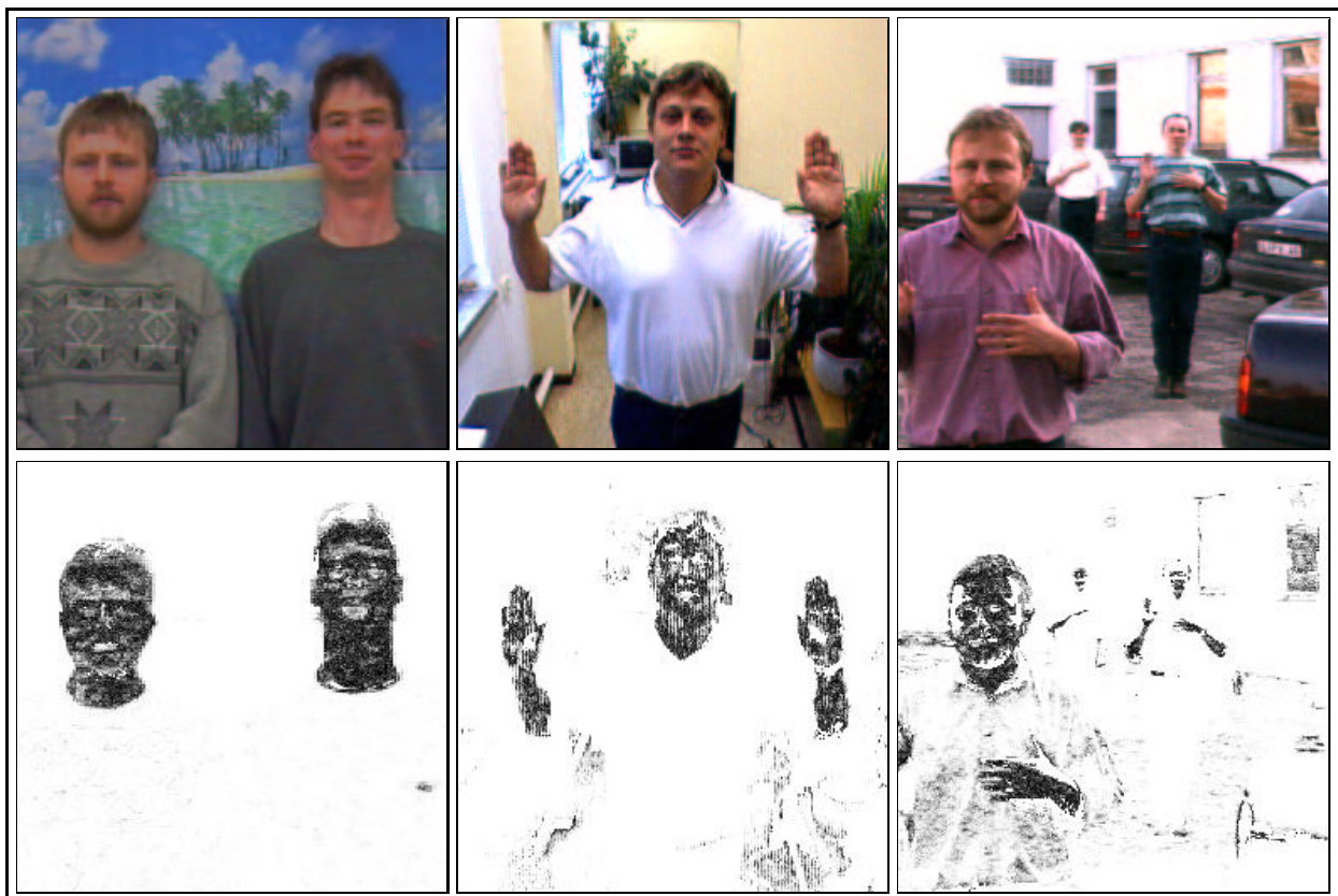
Abbildung 3.9: Beispiele von Ergebnissen der Hautfarbklassifikation im Innen- und Außenbereich. Die Beispiele zeigen, daß die Klassifikation offensichtlich trotz Anwendung eines referenzfreien Farbkonstanzverfahrens (mittleres und rechtes Beispiel) noch von den Umgebungsbedingungen abhängig bleibt. Weitere Erläuterungen werden im Text gegeben.
