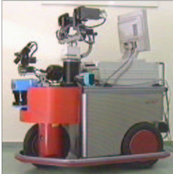
Abbildung 1.2: Das teilautonome mobile Servicesystem MILVA: der auf einem dreirädrigen Fahrwerk aufbauende Roboter mit elektrischem Vorderradantrieb besitzt eine umfangreiche Ausrüstung an Sensortechnik. Dazu zählen insbesondere die beiden oben montierten zoomfähigen S-Video-Kameras, die durch die Montage auf Schwenk-Neige-Einheiten zusammen sieben Freiheitsgrade besitzen. Beide Kameras werden gerade für die Interaktion mit Personen relevant. Die eine der Kameras dient zur Lokalisation von Personen, die andere zur Gestenanalyse. Eine dritte Kamera am Roboterbug dient zur visuell-basierten Navigation. Weitere für die vorliegenden Arbeit allerdings nicht relevante Sensorik ist in Form eines Laserscanners, zweier Infrarotsensoren, eines Ultraschallsensors, taktiler Sensorik sowie zusätzlich durch ein binaurales Hörsystem vorhanden.
