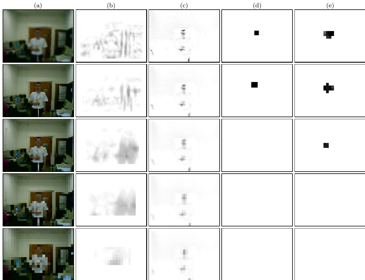
Abbildung 6.18: Lokalisationsergebnis für Versuchsperson Christoph im Innenbereich (2) auf ca. 2,0m: Hier steht die Person in maximaler Entfernung für eine Lokalisation unter den gegebenen technischen Randbedingungen. Was auffällt, ist die Verschlechterung des konturbasierten Ergebnisses in Spalte (b). Das liegt an der zufällig offenstehenden Seitentür (im Bild rechts), die mit einem hellen Plakat beklebt ist, was ganz automatisch auf bestimmten Auflösungsebenen vom konturbasierten Verfahren als ähnlich zu Bestandteilen der typischen Kopf-Schulter-Partie gewertet wird. Ähnlich verhält es sich beim sichtbaren vertikalen Spalt zwischen den beiden Türen, was sich in den großflächigen Fehldetektionen auf der 2. und 3. Ebene (3. und 4. Zeile) niederschlägt. Damit ist auch eine bestimmte Grenze für das Verfahren dieses Cues aufgezeigt. Interessant ist vielleicht noch, daß man hautfarbbasiert deutlich die Hände lokalisieren kann (Spalte (c)), ein Nebeneffekt, der durch das von der Person gehaltene Maßband mit ins Bild gekommen ist. Weitere Einzelheiten stellt Tab. 6.5 auf S. 98 dar.
