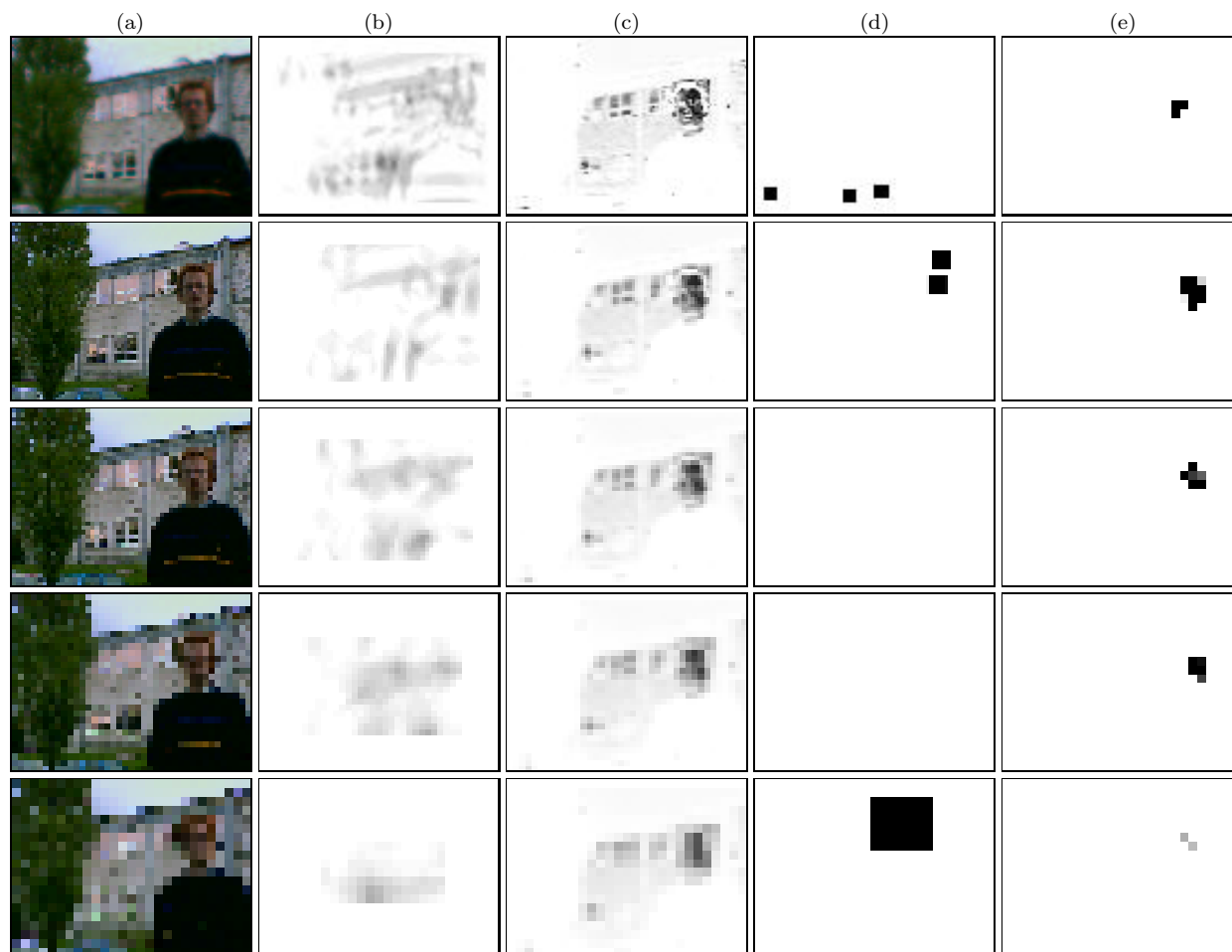
Abbildung 6.12: Lokalisationsergebnis für Versuchsperson Autor im Außenbereich auf ca. 1,5m: Gegenüber den Abbn. 6.10 und 6.11 ist der Abstand der Person zur Kamera soweit vergrößert worden, daß das Gesicht auf der nächstfeineren Ebene detektiert wird, Spalte (d), 2. Zeile. Dadurch verschiebt sich das Blobzentrum in Spalte (e) hin zur 2. Zeile (1. Ebene). Die klaren Fehldetektionen von Gesichtern auf anderen Ebenen können wirksam unterdrückt werden. Anders als die beiden anderen Merkmale wird die Gesichtsdetektion generell nachbearbeitet, indem an die entsprechenden Koordinaten ein Rechteck genau der GesichtsfILTERgröße hineinprojiziert wird, da das Merkmal praktisch nicht translationsinvariant ist, wie das z. B. bei der Kopf-Schulter-Partie (in Grenzen) der Fall ist, so daß hier eine gewisse lokale Ausbreitung nicht inhärent ist. Die Rechtecke erscheinen entsprechend auf groben Auflösungsebenen größer als auf feinen. Weitere Einzelheiten stellt Tab. 6.2 auf S. 90 dar.
