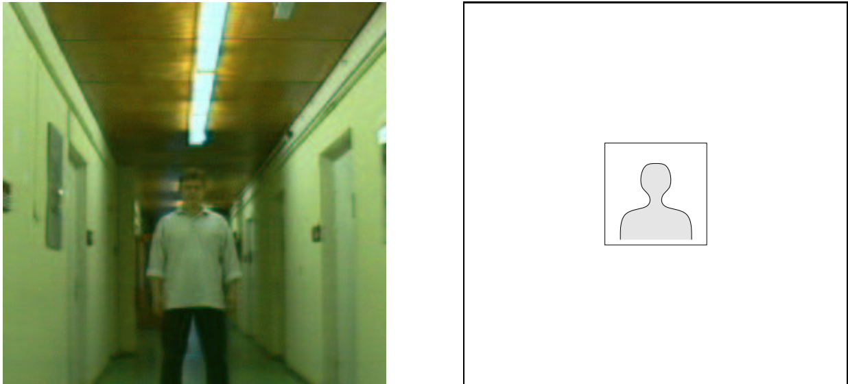
Abbildung 5.2: Prinzip der Konturdetektion zur Lokalisation einer Person anhand des Umrisses ihrer frontalen Kopf-Schulter-Partie: links ein Beispiel eines kontrastarmen Bildes einer Person, das aufgrund der konkreten Umgebungsbedingungen eines Ganges wenig intensitäts- und farbgesättigt ist; rechts die schematische Darstellung des Umrisses der Kopf-Schulter-Partie in korrespondierender Lage und Größe.
